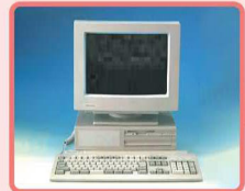
平成3年 CHAPPY H32 H32 チャイルド社コンピュータ部 初代ハードディスクコンピュータ ハードディスク40MB メモリ1MB
